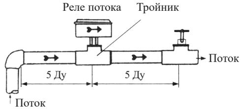
2. Расстояние до других элементов трубопровода (колен, изгибов, стыков, клапанов и др.) должно быть не менее 5 Ду (внутренних диаметров трубы).
